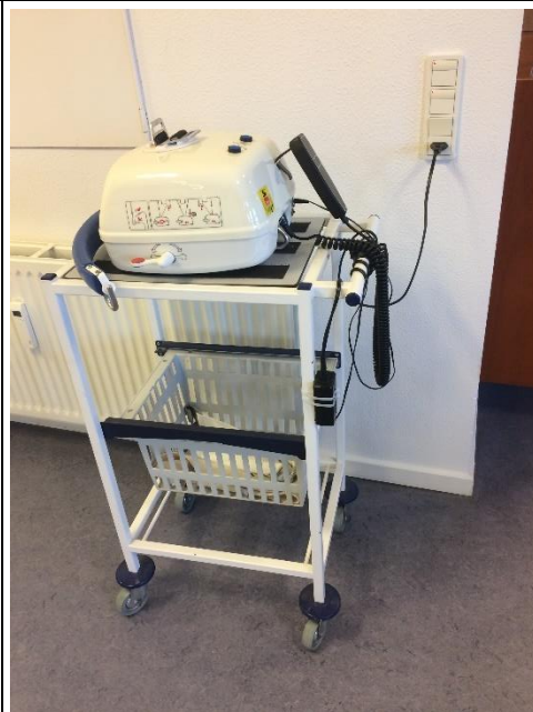
Foto 4 Blok C, 2. sal. Opladning af loftlift i flugtvejsgang.
